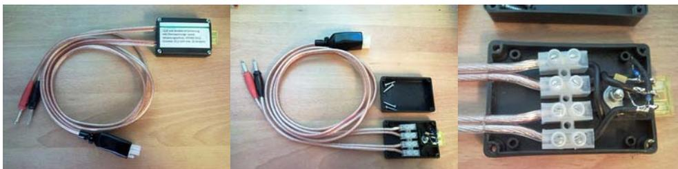
Die Auswahl der Bauteile ist auf handelsübliche Funkgeräte der 100 Watt-Klasse ausgelegt. Unbedingt sollte jedoch speziell hinsichtlich Spannung und Strom die Bedienungsanleitung des angeschlossenen Verbrauchers beachtet werden!
